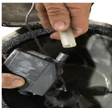
Trouvez le tube et attachez-le à la pompe. Le débit d'eau peut être réglé à l'aide du cadran situé à l'avant de la pompe.
