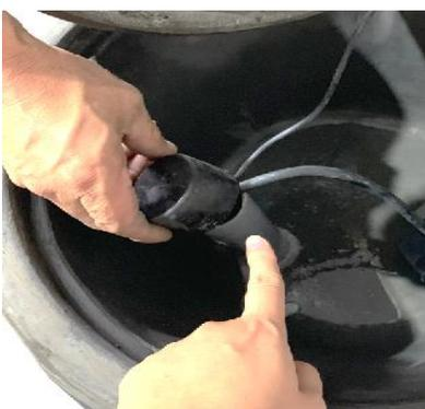
Installez le couvercle du tuyau de cordon sur le tuyau et les cordes. Cet accessoire aide à éliminer le potentiel de perte d'eau pendant le fonctionnement.
