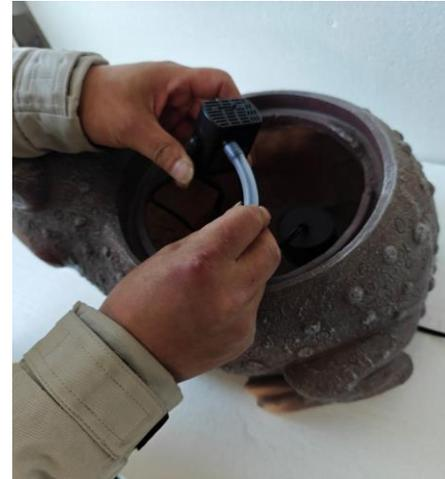
Fixez le tube au raccord de la pompe. Si nécessaire, le débit d'eau peut être ajusté par le cadran situé à l'avant de la pompe.
