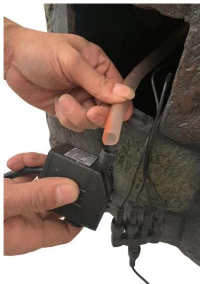
Trouvez la tubulure préinstallée et fixez-la à la pompe. Le débit peut être ajusté à l'aide du cadran de commande situé à l'avant de la pompe. Placez la pompe à l'intérieur de la fontaine.
