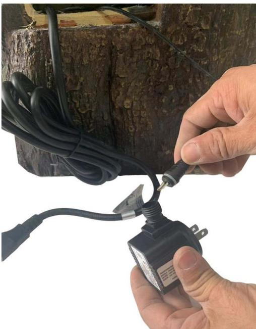
Trouvez et récupérez la connexion lumineuse à l'intérieur de la fontaine. Fixez solidement la lumière au transformateur.
